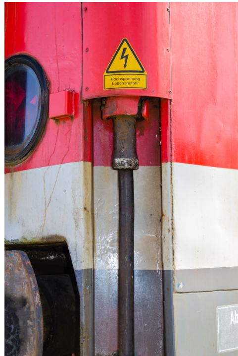
Abbildung 37: Nicht verbundene Zugsammelschiene an einem Reisezugwagen
