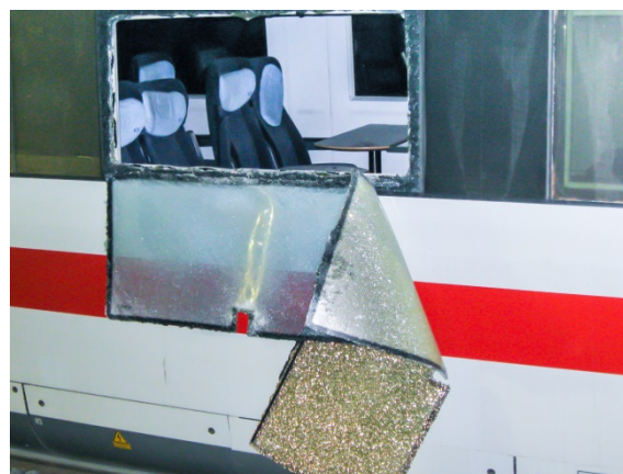
Abbildung 46: Notausstiegswindeln lassen sich nach außen wegdrücken
