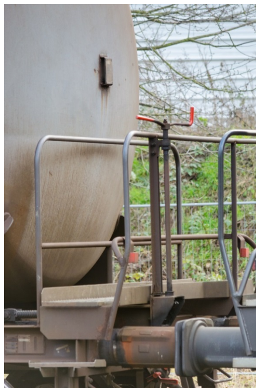
Abbildung 39: Feststellbremseinrichtungen auf der Pufferbrücke
