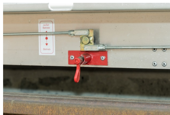
Abbildung 54: Ausschalten der Bremse
