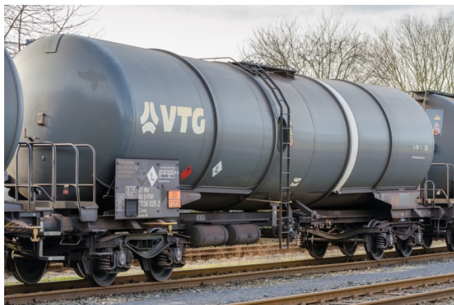
Abbildung 27: Kesselwagen für flüssige Stoffe
