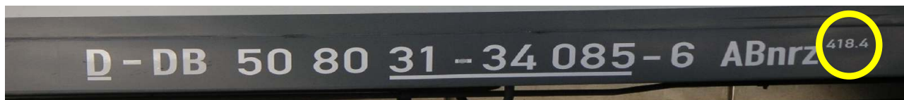
Abbildung 29: Zwölfstellige Fahrzeugnummer mit Bauartnummer
