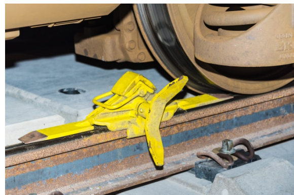
Abbildung 41: Radvorleger werden auf der Schiene befestigt
