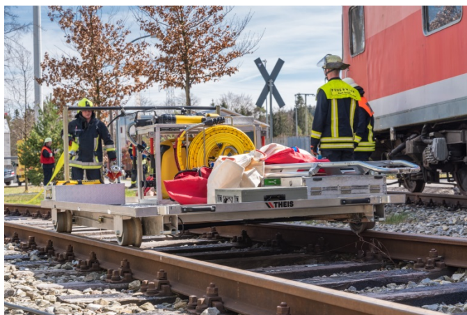
Abbildung 18: Die schienenengebundene Rollpalette ist Bestandteil des Rüstsatzes Bahn
