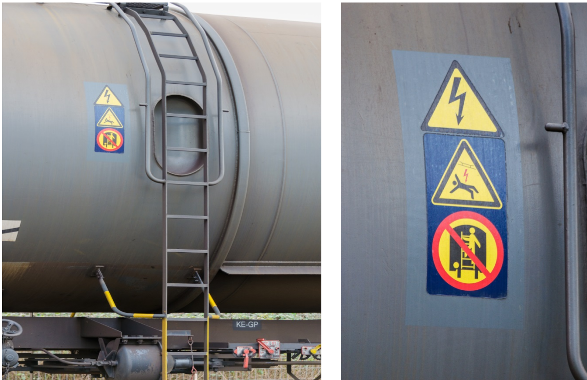
Abbildung 4: Warnhinweis Oberleitung an Fahrzeugen
